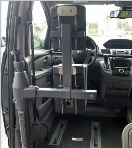
eFutureSafe ausgeklappt; geeignet für fast alle gängigen Rollstuhltypen
