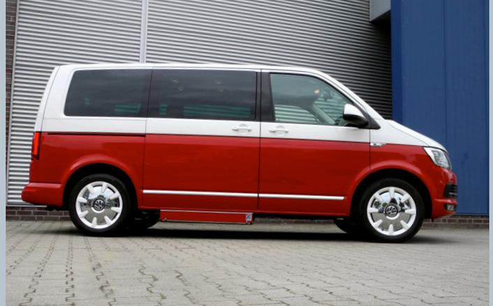
Der ultraflache Kassettenlift garantiert die größtmögliche Bodenfreiheit.
