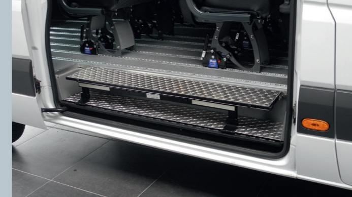
Die hochgeklappte Trittstufe ist mit dem Fahrzeugboden eben.
