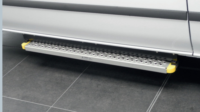
Trittstufe in Ruhestellung unter dem Fahrzeug montiert.
